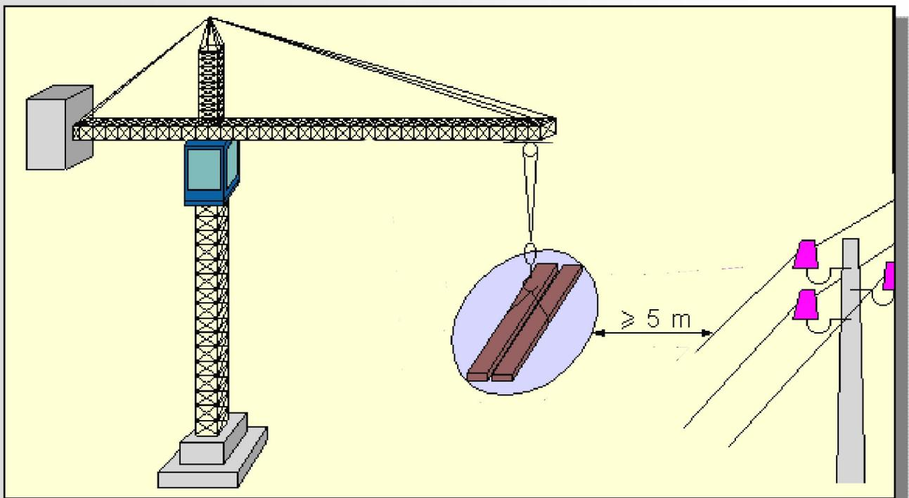
*Non possono essere eseguiti lavori in prossimità di linee elettriche aeree a distanza minore di m 5; detta distanza minima deve essere rispettata sia dagli elementi strutturali del braccio sia dai carichi sospesi movimentati.*
