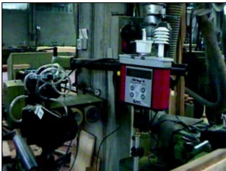
Figura 2.6: Postazione di campionamento ambientale simultaneo IOM e selettore c.d. "a conetto". Nell'immagine è mostrata la strumentazione per la registrazione dei parametri microclimatici.
