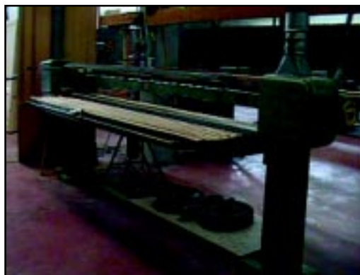
Figura 2.1: Esempi di tipiche macchine utensili in uso nelle falegnamerie. A destra si ha una sega a nastro verticale; a sinistra una carteggiatrice orizzontale provvista delle aspirazioni per la polvere prodotta.
