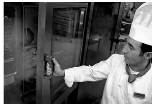
Fig. 7: chi apre lo sportello può usarlo come protezione per evitare brutte scottature.
