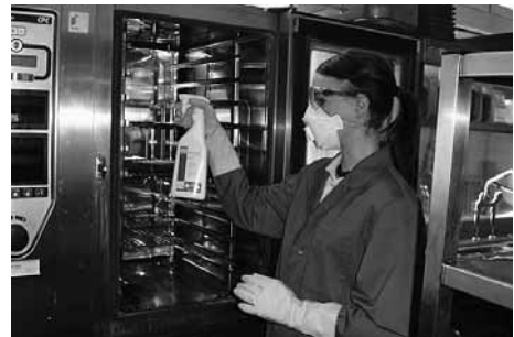
Fig. 18: quando si spruzzano detersivi concentrati la maschera di protezione FFP2 protegge le vie respiratorie.
