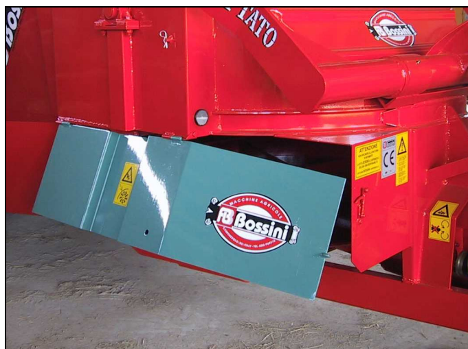
PROTEZIONE DELL'ORGANO SPANDITORE. RIPARO IN POSIZIONE DI CHIUSO QUANDO LA MACCHINA NON E' UTILIZZATA E IN POSIZIONE DI APERTO DURANTE LO SPANDIMENTO
